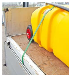
Fissaggio con fasce
