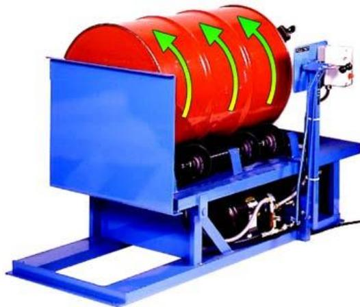
Il motore idraulico a velocità variabile permette di girare il fusto da 5 a 20 RPM
