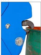
• Sollevamento idraulico manuale tramite pompa. Sono necessari 27 azionamenti manuali della pompa a mano per sollevare un fusto alla massima altezza.
